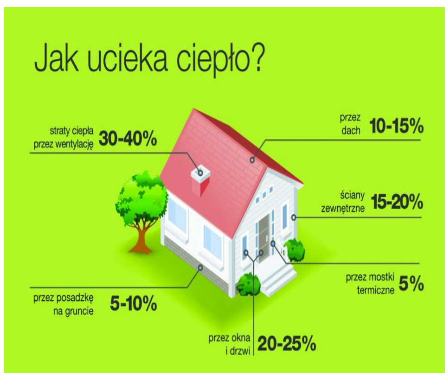
Rysunek 8. Straty ciepła. Źródło: Instytut Budynków Pasywnych przy Narodowej Agencji Poszanowania Energii / Całkowite straty ciepła w budynkach standardowych
