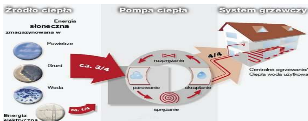
Rysunek 6. Schemat działania pompy ciepła (www.alpha-innotec.pl)
