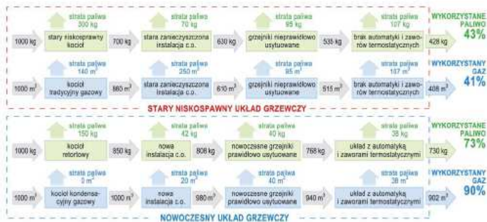
Rysunek 9. Porównanie sprawności starego niskosprawnego układu grzewczego z nowoczesnym układem
